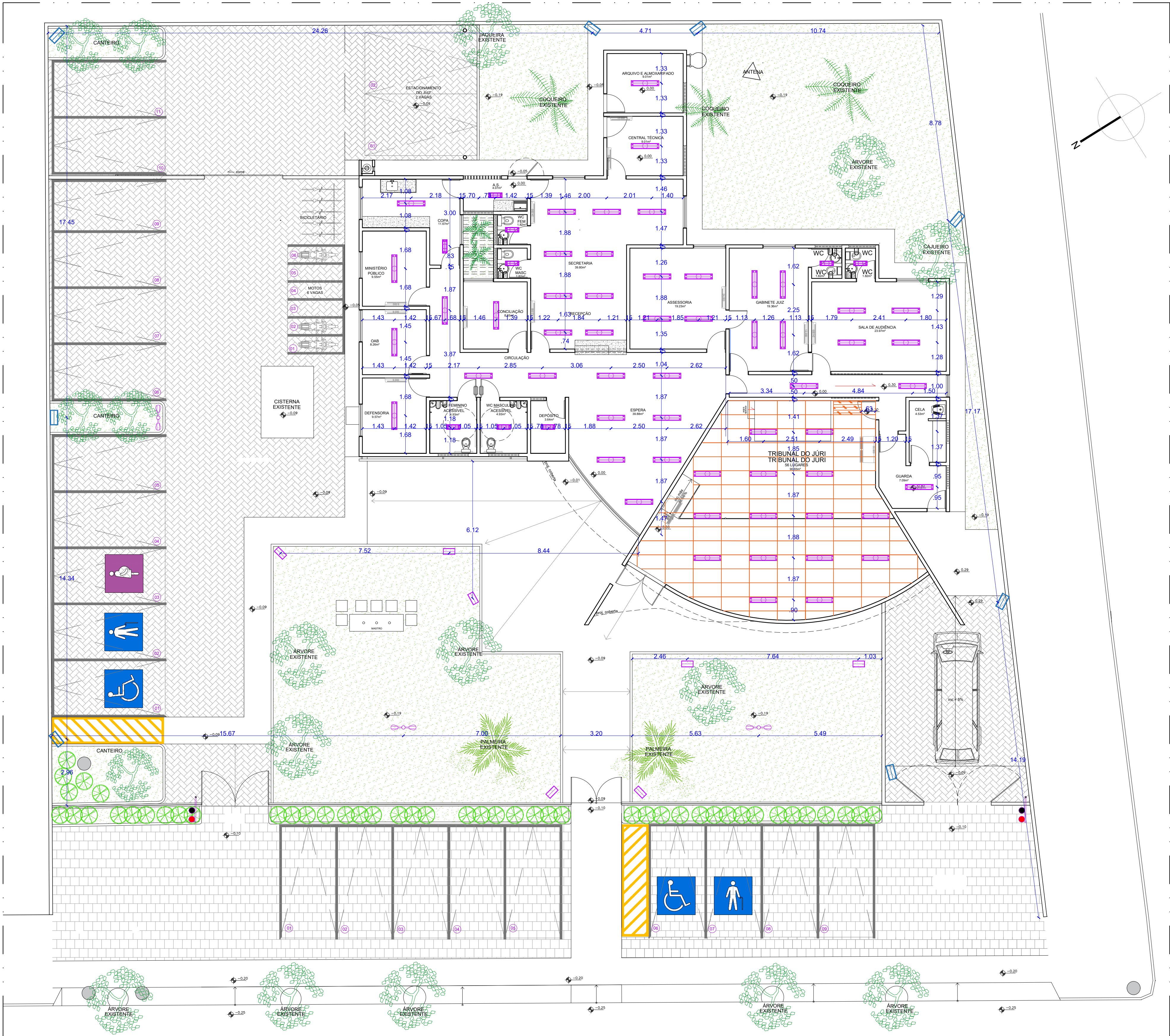
PLANTA DE FORRO E LUMINOTÉCNICA ESCALA 1/100
