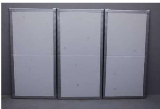
Amostra após 1464 horas de exposição.
