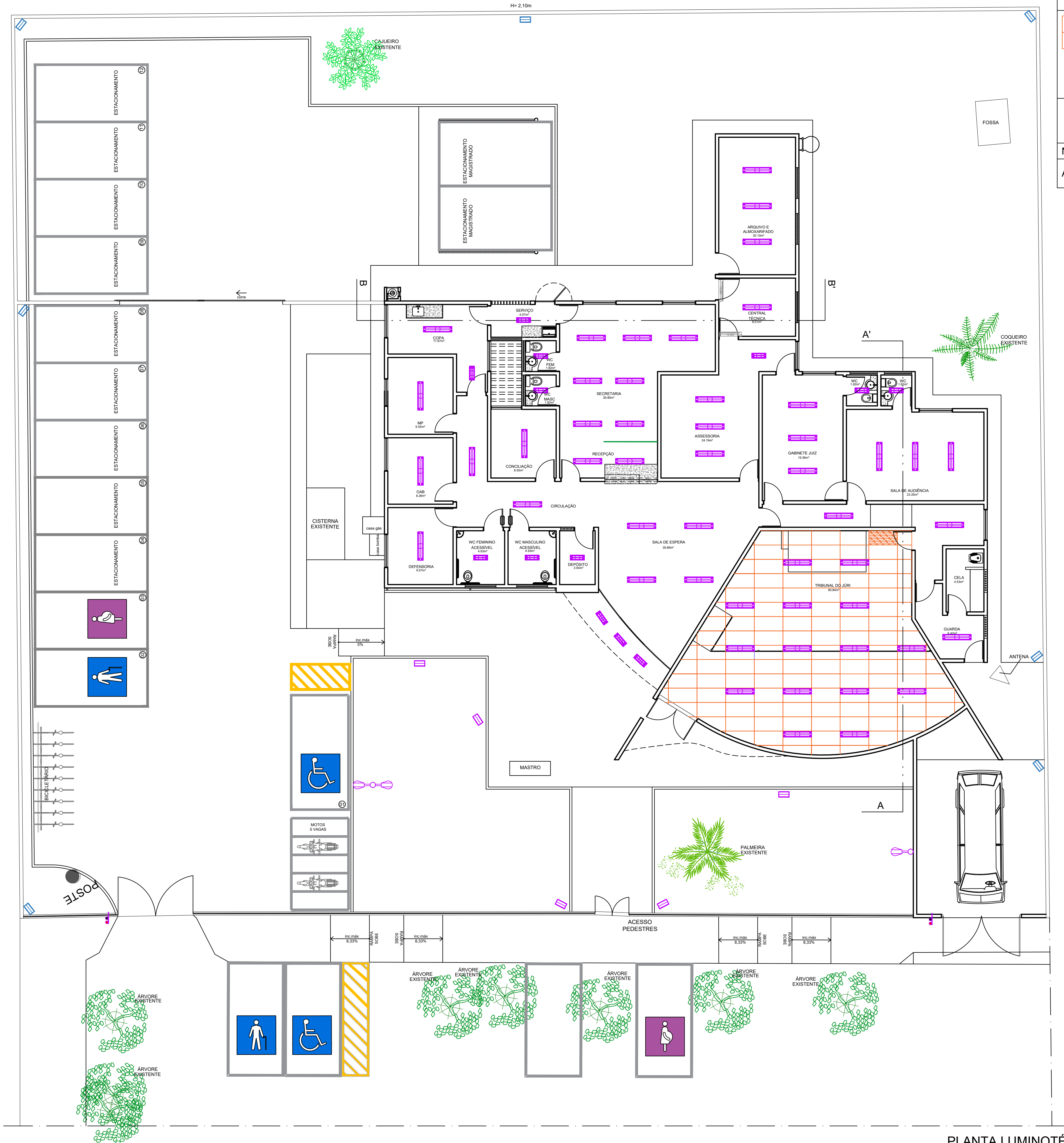
PLANTA LUMINOTÉCNICO esc 1/100
