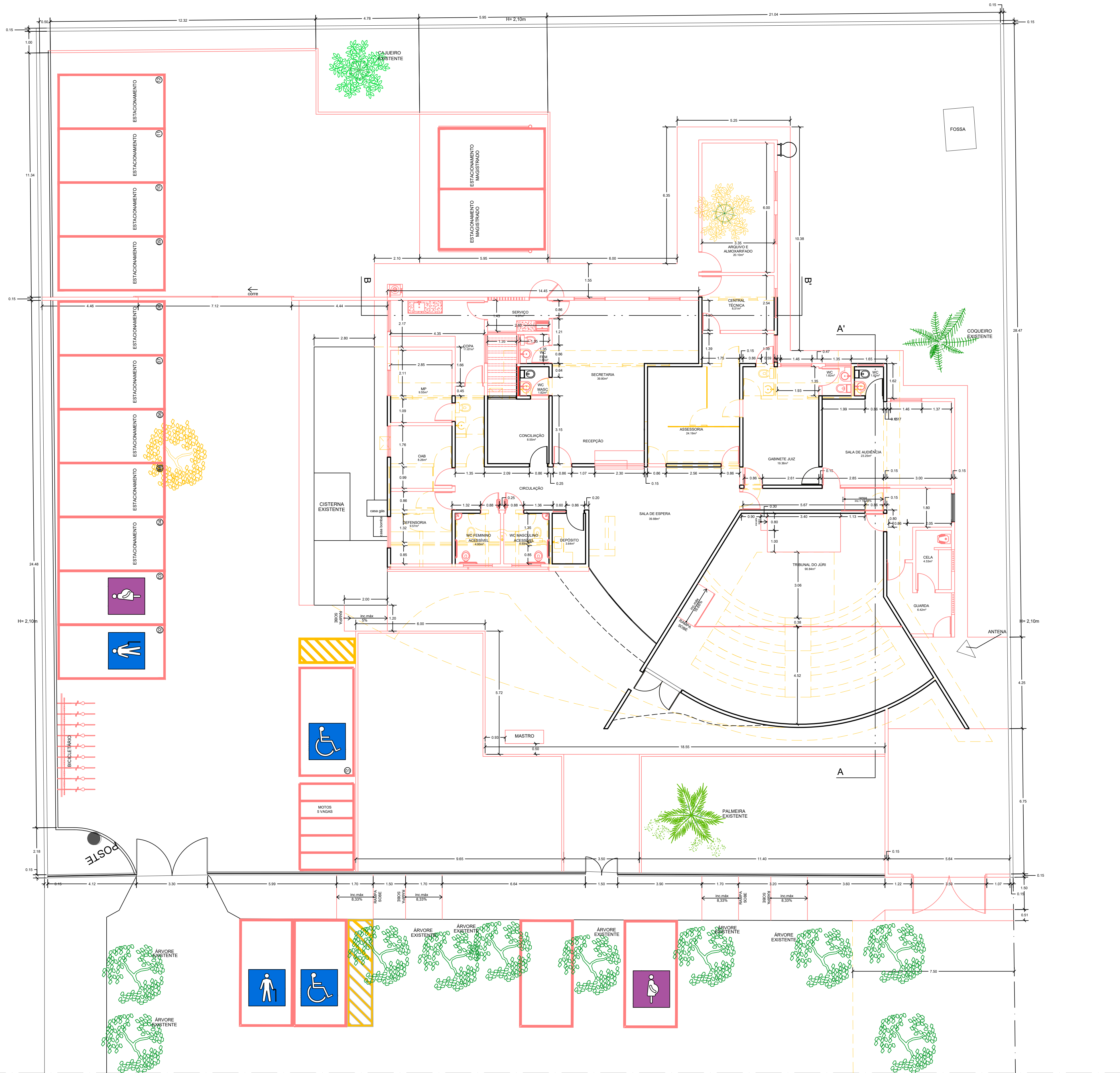
PLANTA CONSTRUIR/DEMOLIR esc 1/100
