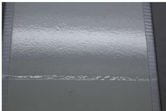
Amostra após 1464 horas de exposição. Detalhe da região de solda.
