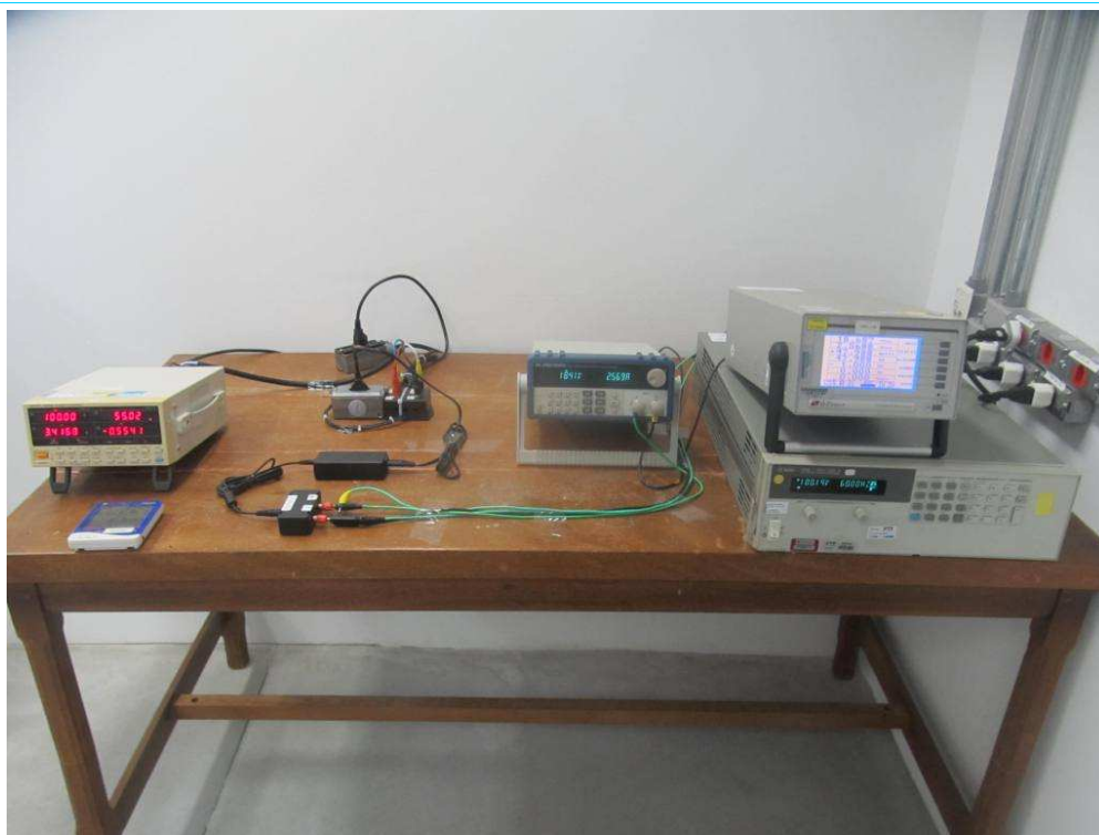
Figura 9 – Configuração de ensaio de Eficiência Energética
