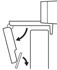
**2** Ajustez la webcam pour vous assurer que le pied du clip de fixation universel est aligné avec l'arrière de votre dispositif.
