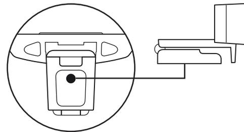
**2** Sécurisez la webcam sur le trépied en la vissant sur le filetage ¼ pouce.
