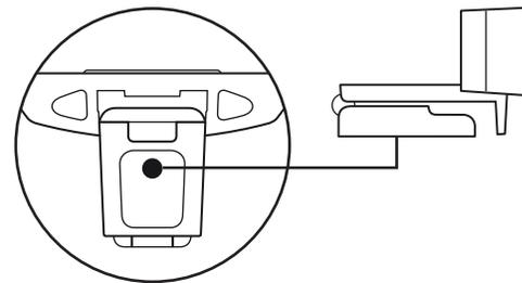
**2** Fija la cámara Web al trípode, girándolo en el adaptador de ¼ de pulgada.
